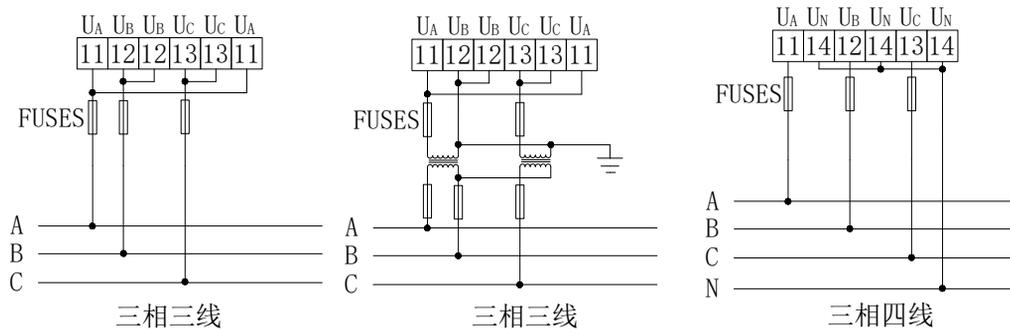
AMC48电压接线
